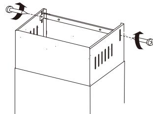
Как показано на рис.11, зафиксируйте внешнюю и внутреннюю часть декоративного воздуховода винтами M4\*8
