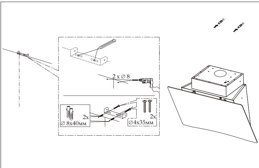
Просверлите два отверстия диаметром 8 мм в стене в соответствии с размером кронштейна и вставьте в отверстия расширяющиеся заглушки.
