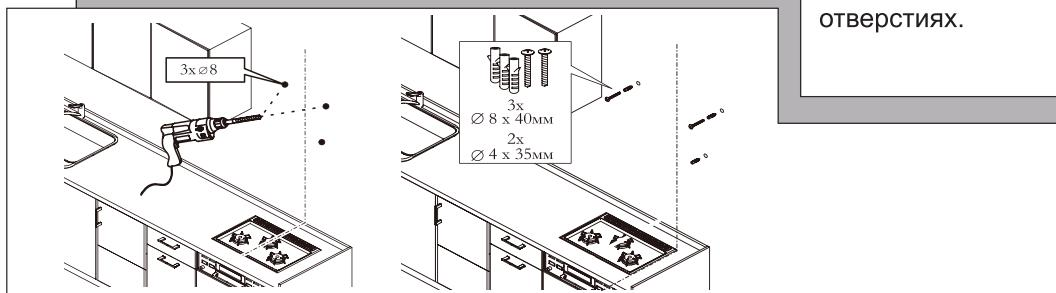
Выровняйте вытяжку на стене в соответствии с рисунком 3. Затем с помощью трафарета просверлите на стене 3 отверстия Ø8. Закрепите 3 комплекта расширяющихся заглушек с предназначенными для них винтами в 3 отверстиях.
