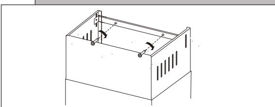
Подвесьте внутреннюю часть декоративного воздуховода и совместите 2 монтажных отверстия с 2 винтами. Затем закрутите оба винта.
