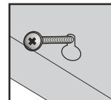
Подвесьте вытяжку, совместите ее 3 установочных отверстия с 3 винтами и отрегулируйте в положении установки.
