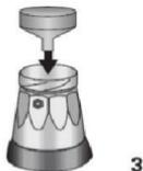
4. Если собираетесь варить не более 3 чашек эспрессо, вставьте в фильтр-воронку адаптер для регулировки крепости кофе, который идет в комплекте (Рис.4).
