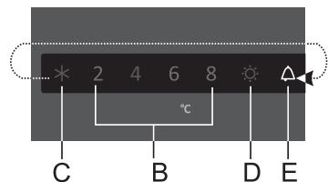
При превышении допустимой температуры в приборе включается прерывистый звуковой сигнал и мигает индикатор **D**.
