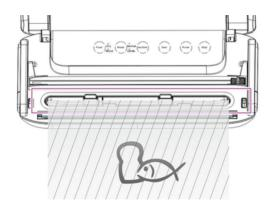
Закройте крышку, нажав на ее края до упора, чтобы послышался щелчок. Для удобства можно защелкнуть сначала один край крышки, а затем — другой. Следите при этом, чтобы пакет не сместился.
