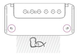
Кнопкой «Давление» выберите обычное либо низкое давление. При выборе низкого давления воздух откачивается не полностью, режим предназначен для упаковки сминающихся продуктов. Возле выбранного режима загорается индикатор. По умолчанию выбрано обычное давление.
