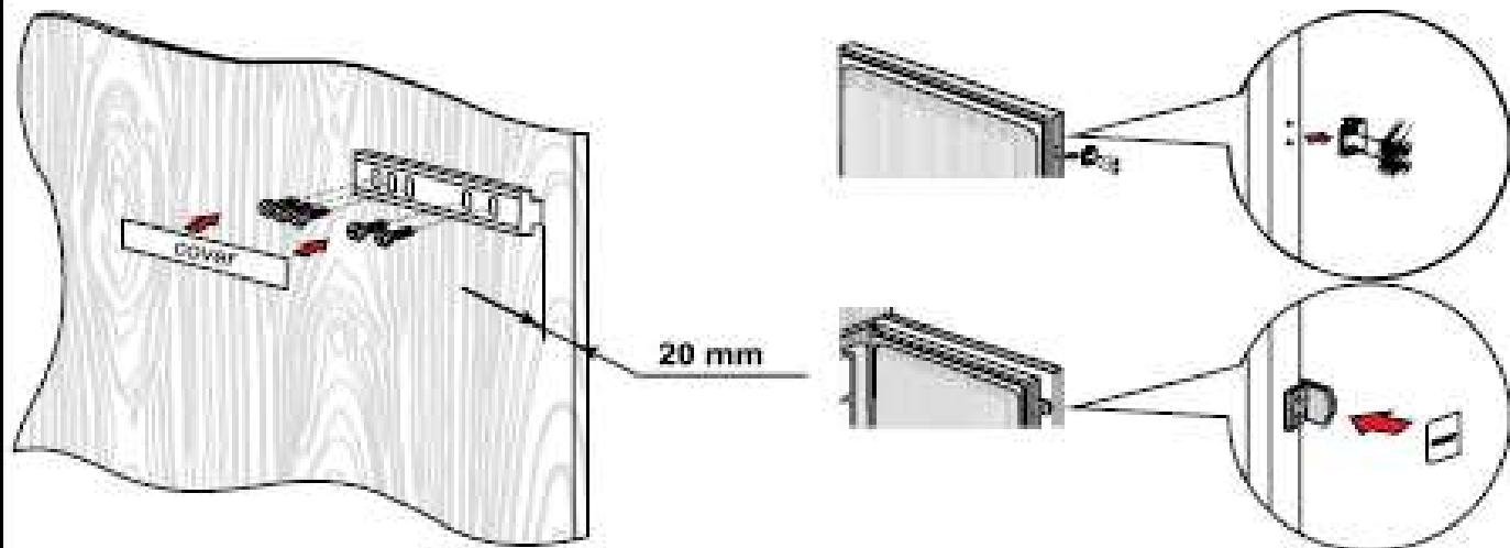
**7.** Установите крышку петли в следующем положении.
