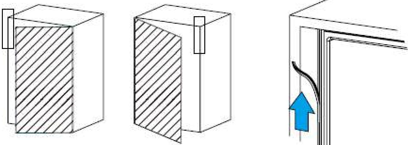
**5.** Установите соединительную пластину следующим образом, как указано на рисунке.
