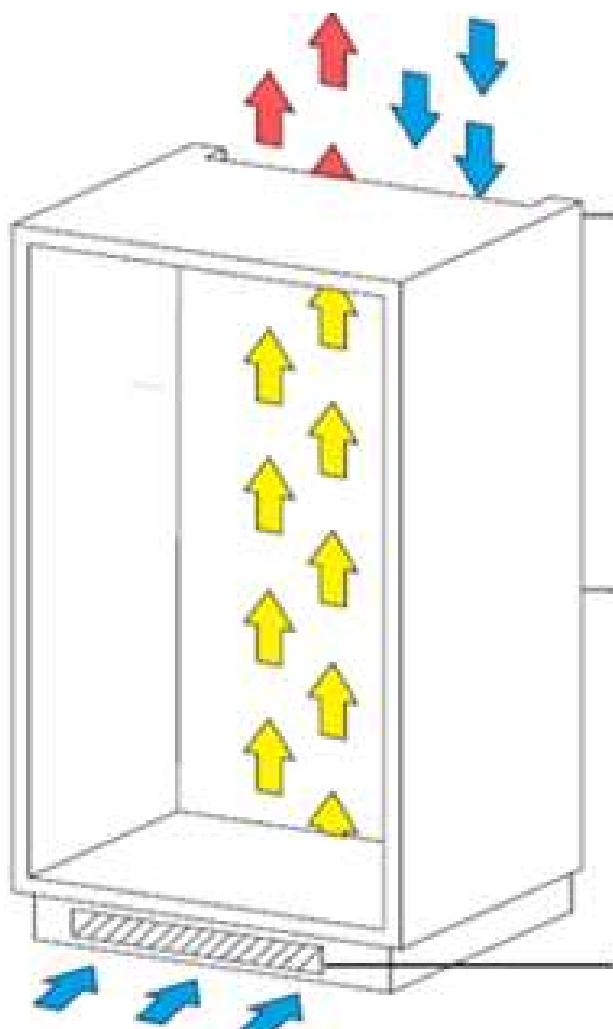
В верхней части шкафа сделайте зазор для вентиляции. Воздушный поток должен свободно проходить и выходить наружу.
