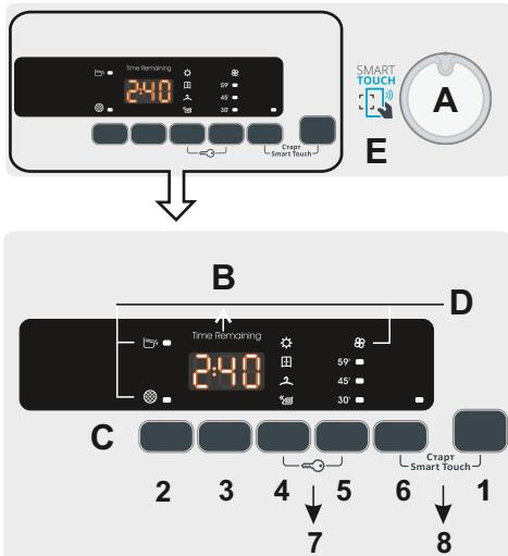
**A – Переключатель выбора программ:** Чтобы выбрать программу, вращайте переключатель в обоих направлениях. Отменить выбранную программу или выключить машину, вращайте ручку до положения OFF.
