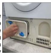
5. Проверьте положение уплотнительной прокладки после чистки. Установите ее в паз, если она сместилась.
