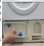
4. Осторожно уберите пыль при помошью ткани, затем промойте фильтр под проточной водой, чтобы вода попадала между пластинами и смывала пыль или ворс.
