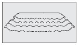
С помощью полочки Вы можете разложить бутылки в холодильнике в горизонтальном положении, чтобы компактно их хранить.
