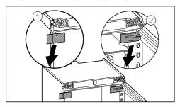
■ Снимите детали облицовки ① и ②.
