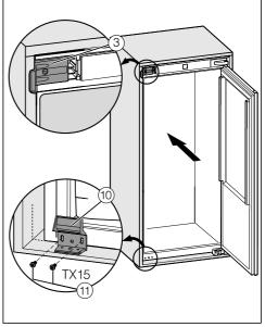
■ Приверните нижний крепежный уголок ⑩ шурупами ⑪ снизу прибора, не затягивая их.
