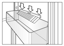
Вставьте держатель бутылок по центру задней кромки полки для бутылок.
