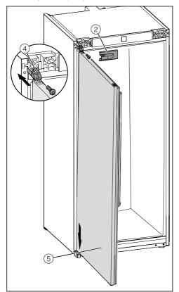
■ Наденьте дверцу прибора ⑤ на шарнир дверной петли сверху.
