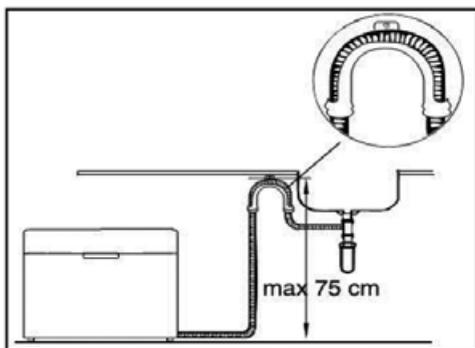
Если установка производится выше уровня столешницы, подключение к сливу производится под раковиной к сифону.
