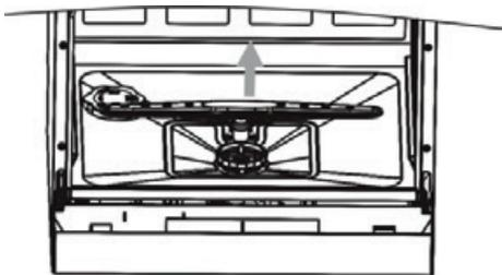
Подвижные форсунки необходимо чистить регулярно, иначе накипь и отложения жесткой воды засорят форсунки и каналы для воды. Для этого открутите гайку, снимите верхнюю часть подвижного механизма и затем снимите форсунку. Вымойте форсунки в теплой мыльной воде и используйте мягкую щетку для чистки отверстий. После промывки установите их обратно.
