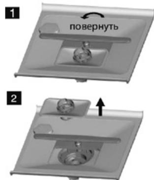
Шаг 1. Поверните верхнюю часть блока фильтров против часовой стрелки.
