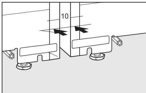
■ Поставьте приборы рядом так, чтобы они спереди были в одной плоскости и между ними оставался зазор 10 мм.
