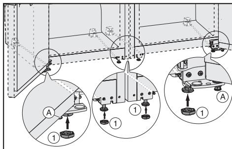
■ Полностью вверните ножки (A) для упора дверец прибора с помощью прилагающегося вилкообразного гаечного ключа ⑯. Они не должны соприкасаться с полом.
