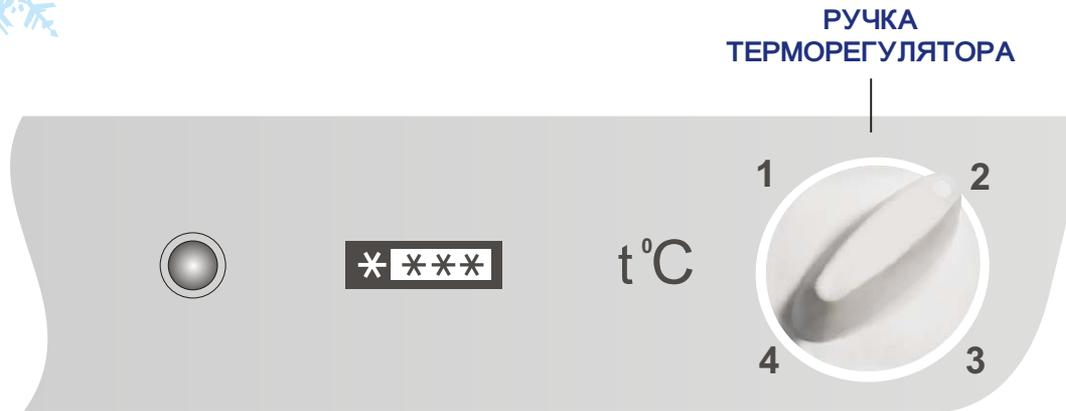
Органом управления холодильника является ручка терморегулятора, с помощью которой производится регулировка температуры. Ручка поворачивается по часовой стрелке и против нее и устанавливается меткой на выбранное деление. Деление «1» соответствует наиболее высокой температуре (наименьшее охлаждение) в камере, деление «4» — наиболее низкой (наибольшее охлаждение).
