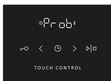
После подключения зонда установите режим нагрева и температуру. На дисплее в течение трех секунд высвечивается надпись Prog. Затем загорается индикатор (зонд) и горит все время, пока зонд подключен к духовке.
