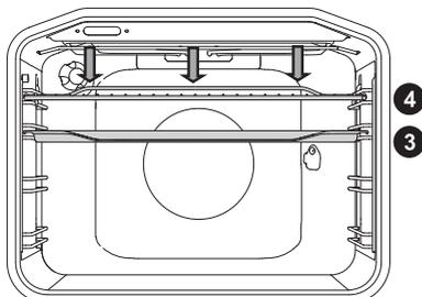
При большом гриле включаются верхний нагревательный элемент и инфранигреватель, расположенные под потолком духовки.
