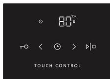
На дисплее мигает установленная по умолчанию температура зонда 80°С, которую можно поменять сенсорами < и >. Температура зонда устанавливается в диапазоне от 30° до 99°С.
