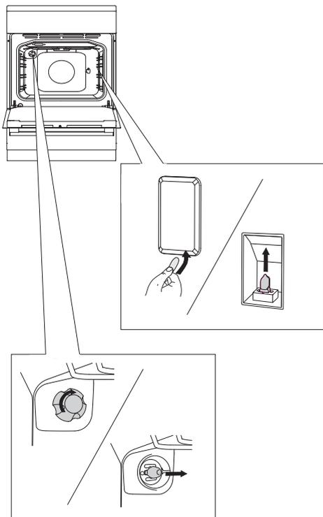
Подденьте крышку шлицевой отверткой и снимите крышку. Открутите лампочку.
