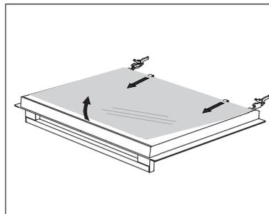
**3** Приподнимите стекло и извлеките его из клипс в нижней части дверцы.
