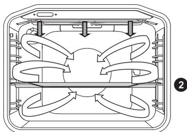
Одновременно работают инфранигреватель и вентилятор. Предназначен для приготовления мяса, рыбы, овощей.
