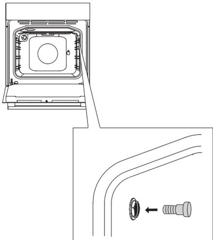
**1** Открутите металлическую заглушку (гнездо для зонда расположено в переднем верхнем углу на левой стенке духовки).
