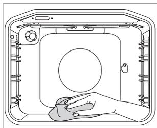
**1** Поверните ПЕРЕКЛЮЧАТЕЛЬ РЕЖИМОВ РАБОТЫ духовки в положение AquaClean. ПЕРЕКЛЮЧАТЕЛЕМ ТЕМПЕРАТУРЫ становите температуру 70°C.
