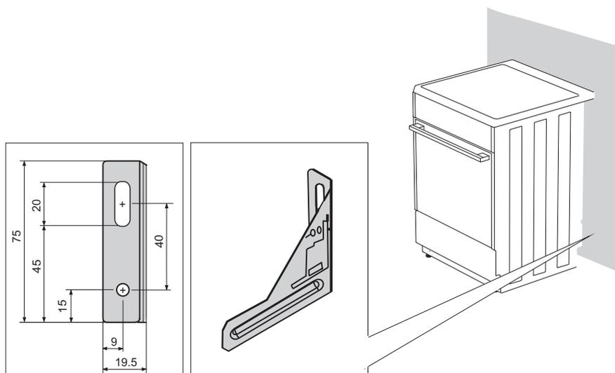
💡 Размеры, приведенные в скобках, относятся к установке с кронштейном без дополнительной подставки. Если прилагаемые в комплекте винты и дюбели не обеспечивают надежный монтаж кронштейна, используйте другой крепежный материал, который обеспечит основное предназначение кронштейна — защиту от опрокидывания.
