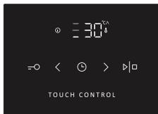
После установки температуры зонда нажмите и удерживайте сенсор СТАРТ/СТОП для пуска программы. Во время приготовления на дисплее попеременно загорается заданная и текущая температура. Слева высвечивается температурная шкала.
