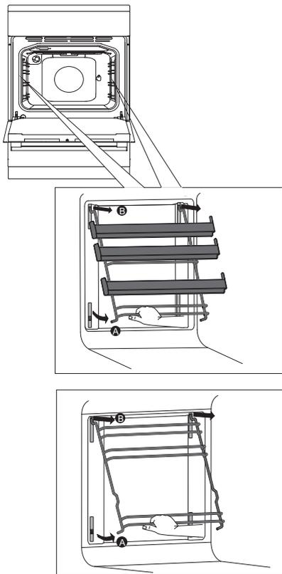
**A** Приподнимите направляющие снизу и отведите от стенки духовки.
